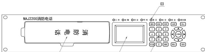
1: 总机手柄 2: 液晶显示屏 3: 状态指示灯 4: 操作按键
