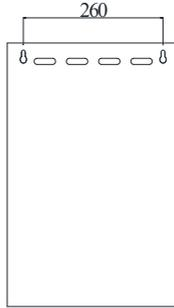
图 2-7 壁挂安装尺寸
