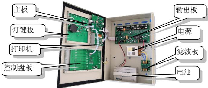
图2-2 内部结构与连接
